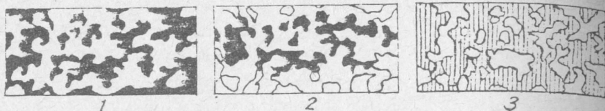
Fig. 147. Cedarea substanței active dintr-un comprimat cu matriță inertă: 1 — comprimatul în starea inițială (negru — substanța activă solubilă; hașurat — matrița inertă nedigerabilă); 2 — o parte de substanță a fost cedată; 3 — matrița inertă după ce substanța activă a difuzat complet
