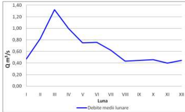
Fig. 21. Debitele medii multianuale ( m^3/s ) la stația hidrometrică Galbeni în perioada 1950-2011 (prelucrare după date S.G.A. Galați)
