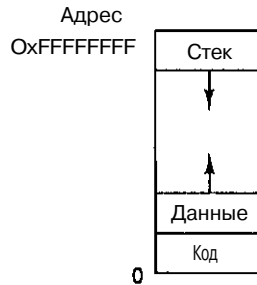
Рис. 6.26. Адресное пространство одного процесса UNIX
