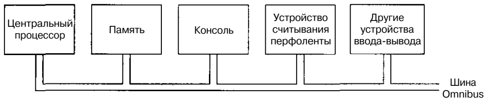
Рис. 1.5. Шина компьютера PDP-8
