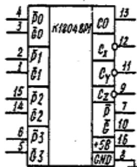
Рис. 87. Схема ускоренного переноса 1804BP1
