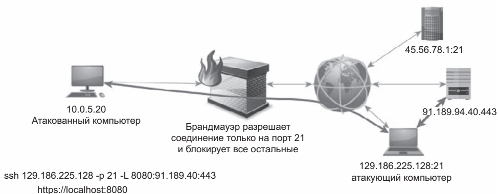
Рис. 14.3. Локальное перенаправление портов с использованием SSH
