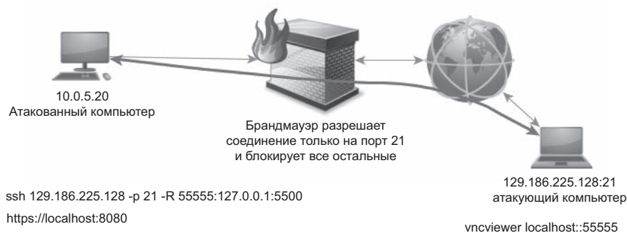
Рис. 14.4. Удаленное перенаправление портов с использованием SSH
