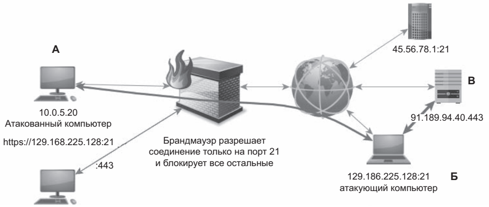
Рис. 14.2. Поток данных после перенаправления
