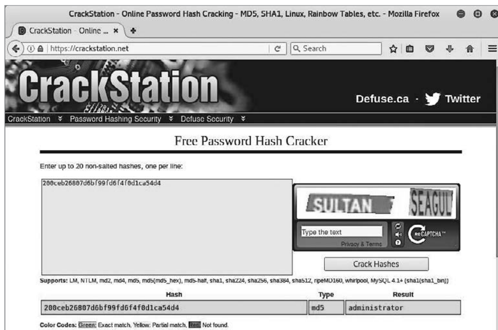
Рис. 6.1. Пример использования радужной таблицы
