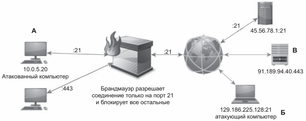
Рис. 14.1. Поток данных без перенаправления
