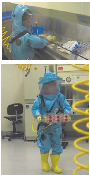
Fig. 1.18. Echipament de protecție personală complet: costum, încălțăminte și respirator cu filtre prevăzută pentru activități cu clasa 4 de risc
