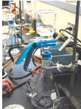
Fig. 2.15. Filtre utilizate în filtrarea lichidelor
