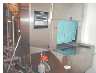
Fig.2.9. Instalație pentru curățarea carcaselor de la animale
