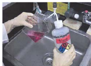
Fig. 5.14. Dezinfectarea deșeurii lichide cu hipoclorit de sodiu de 10%
