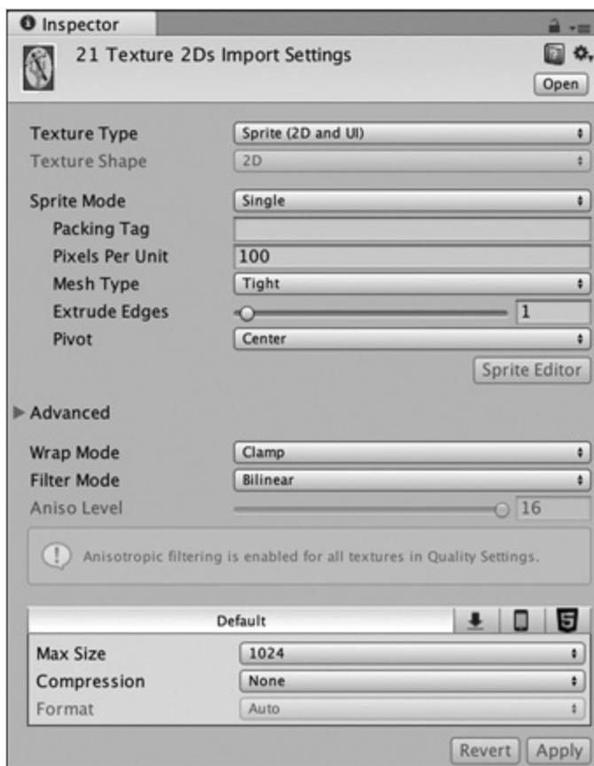
Рис. 32.2. Настройки импортирования двумерных текстур в спрайты
