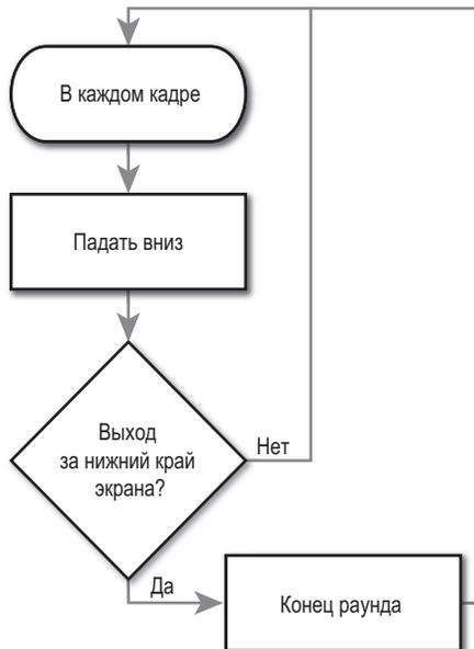
**Рис. 16.4.** Блок-схема Яблока
