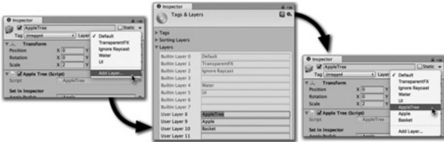
Рис. 28.8. Процедура создания новых физических слоев (шаги 1 и 2) и их привязки (шаг 5)
